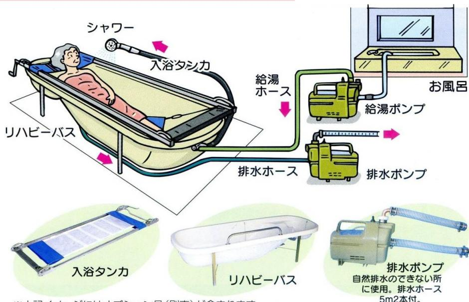
浴室以外に簡易浴槽を設置する場合、ご自宅の浴槽に溜めたお湯を、給湯ポンプでくみ上げて簡易浴槽へお湯を運びます。排水は、排水ポンプを使用して、浴室の排水口等へ排水いたします。
